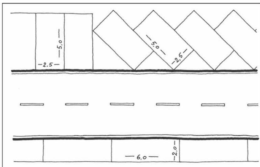
Figure 5 : dimensionnement des emplacements pour voitures
