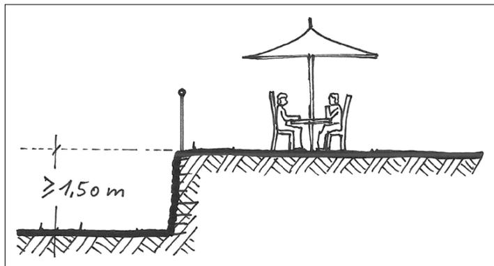
Figure 4 : garde-corps dans les aménagements extérieurs
